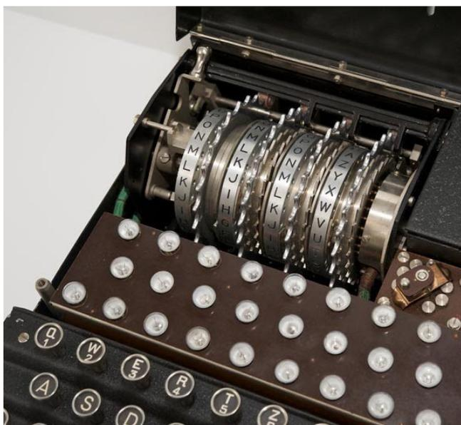
а) четыре последовательно соединённых ротора
