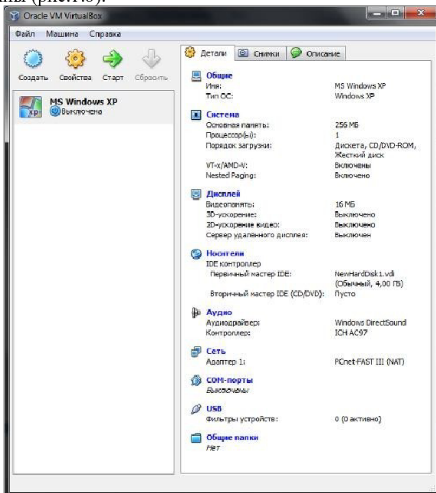
Рис. 1.8. Консоль управления виртуальных машин «Oracle VirtualBox»
