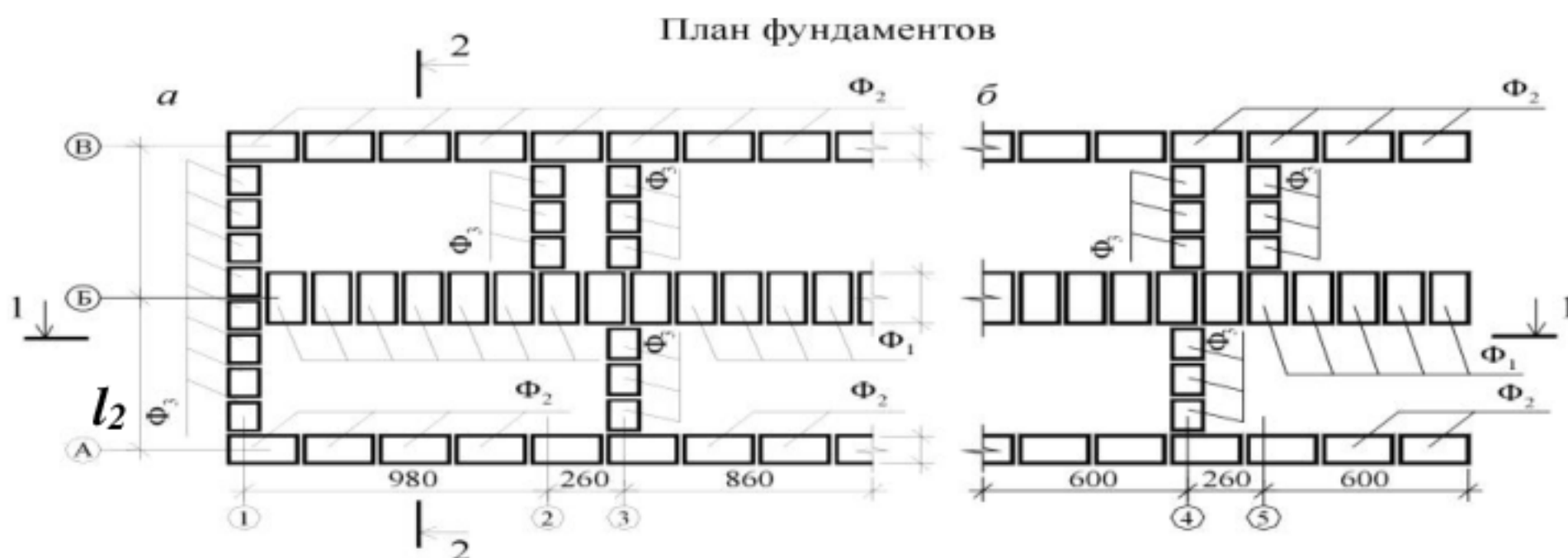
Рис. 1. Планы фундаментов и раскладки плит перекрытия над l_1 подвалом:
