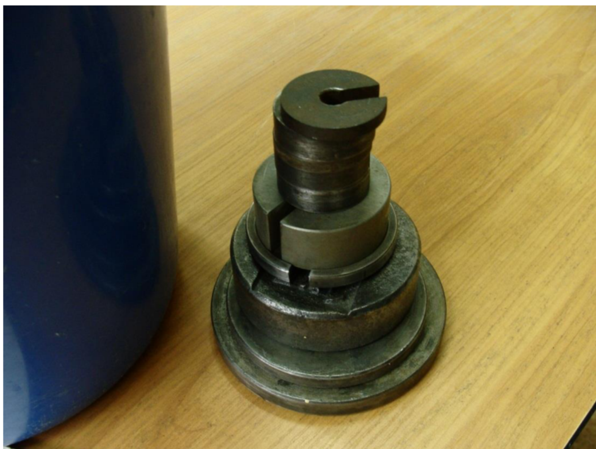
Рис. 5.6.4. Комплект разновесов для выполнения лабораторной работы
