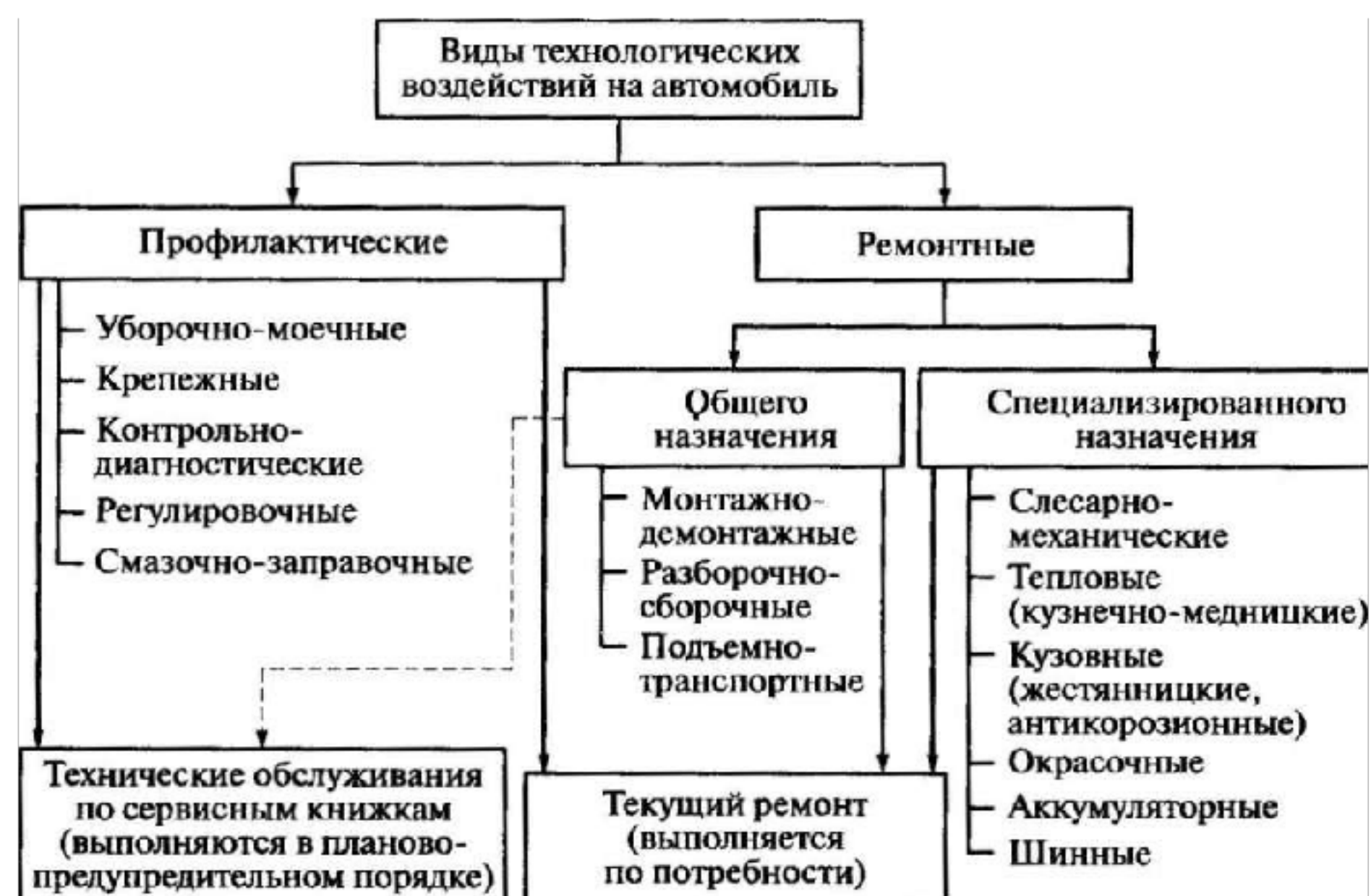
Рис. 6.1. Виды технологических воздействий (работ) по поддержанию автомобиля в работоспособном состоянии
