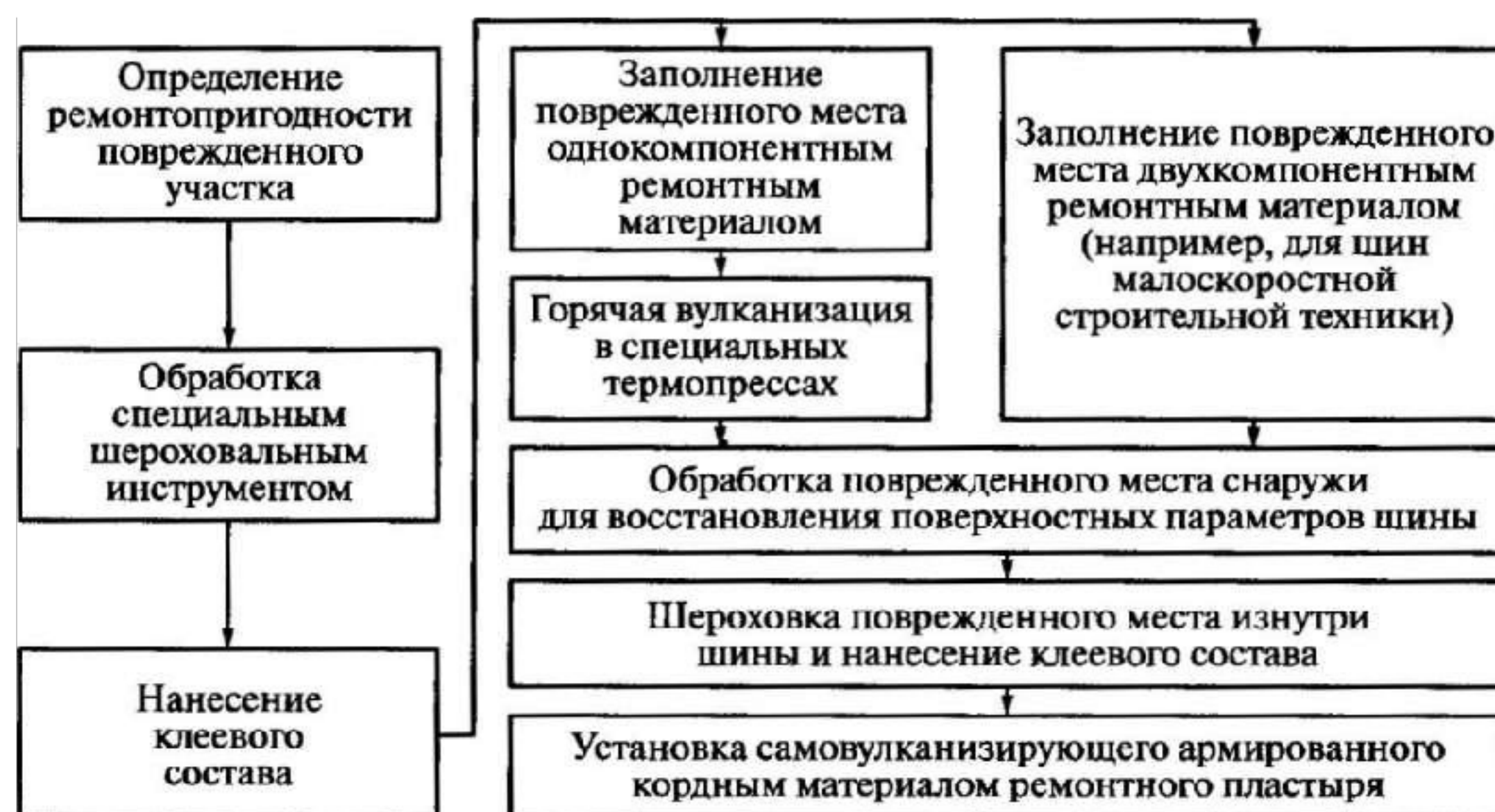
Рис. 6.8. Основные этапы ремонта сквозных повреждений шин
