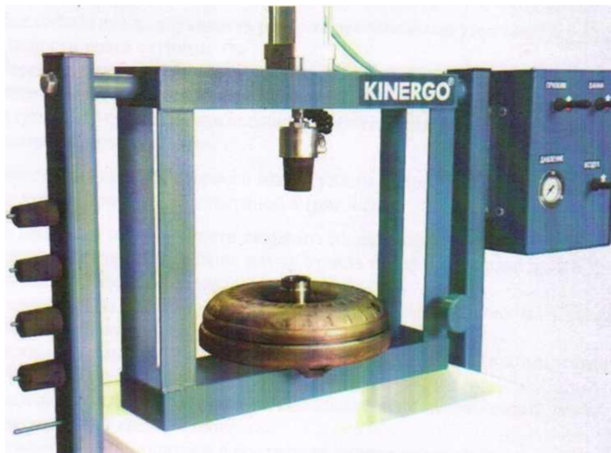
Рисунок 3 - Установка гидротрансформатора на основание.
