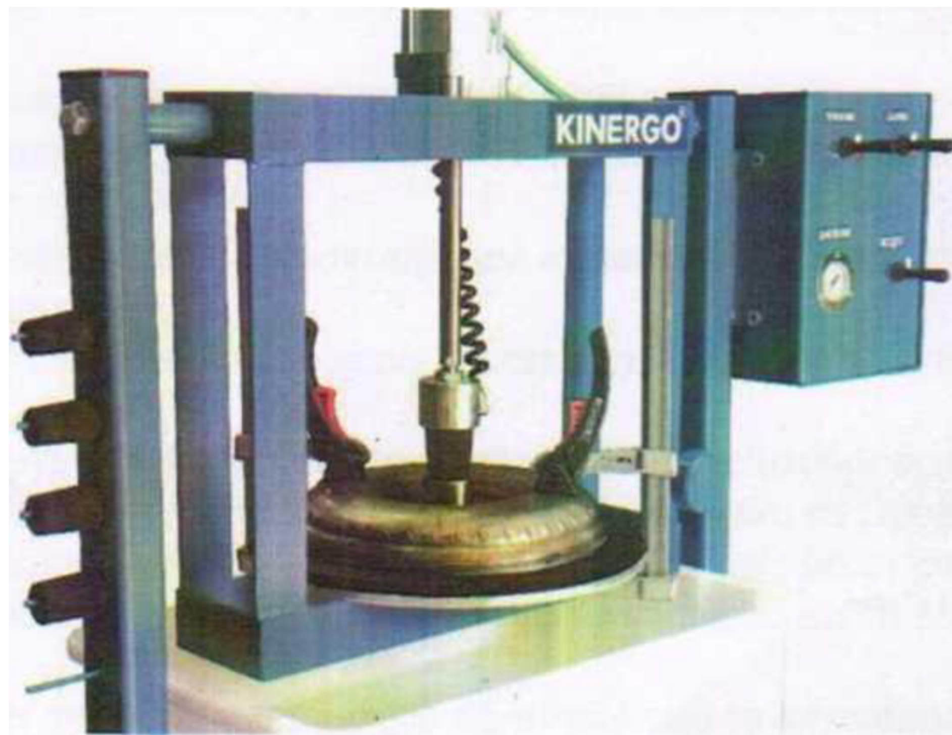
Рисунок 5 – Проверка герметичности соединения гидротрансформатора
