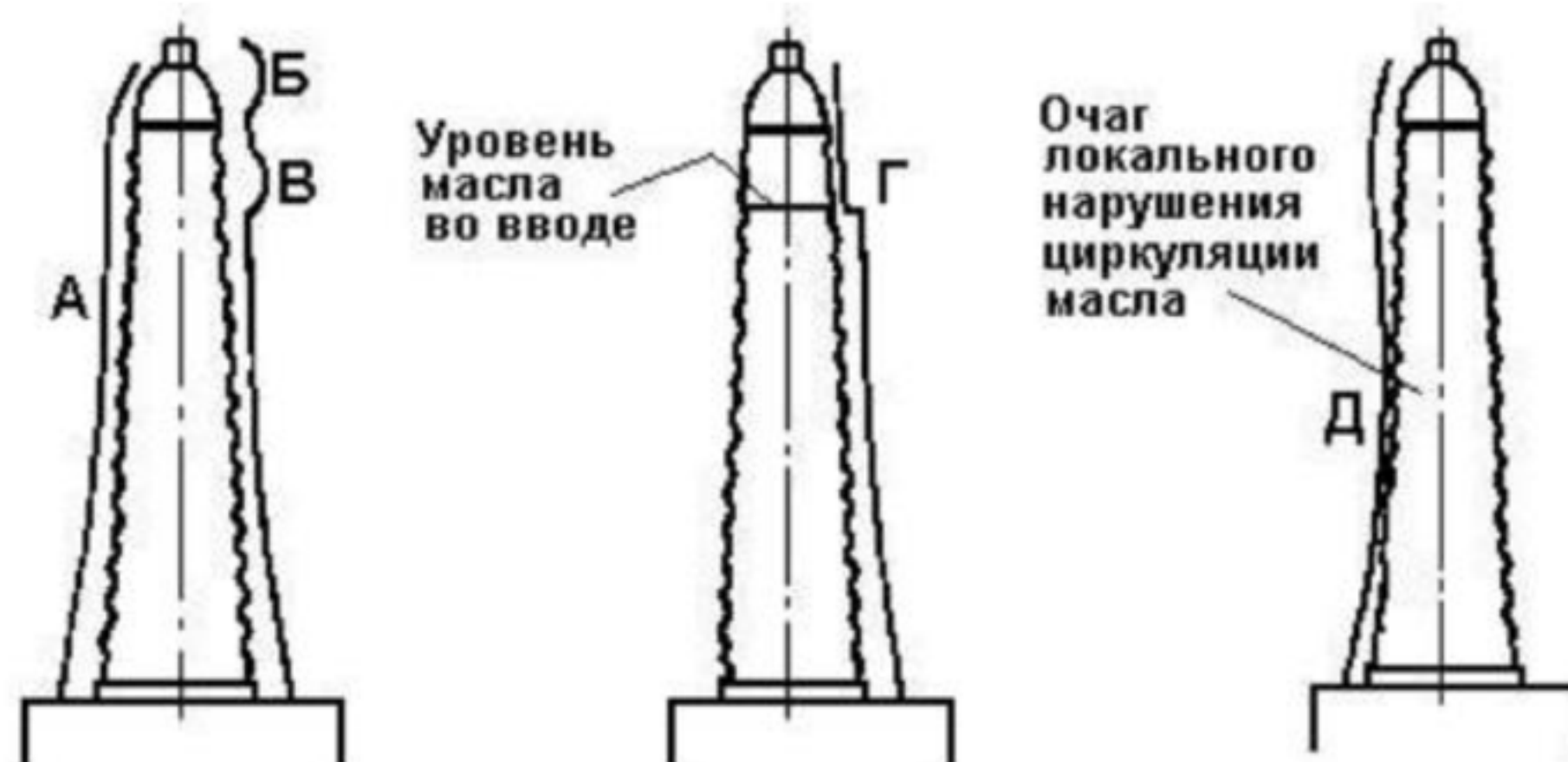
Рисунок 3 - Характер распределения температуры по высоте маслonaполненного ввода.
