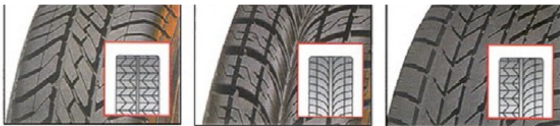
Рис. 1 Дорожные шины с разными типами рисунка: а – ненаправленный; б – направленный; в – ассиметричный
