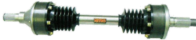
Рисунок 2. Тюнинг-овый ведущий вал с усиленными шарнирами равных угловых скоростей
