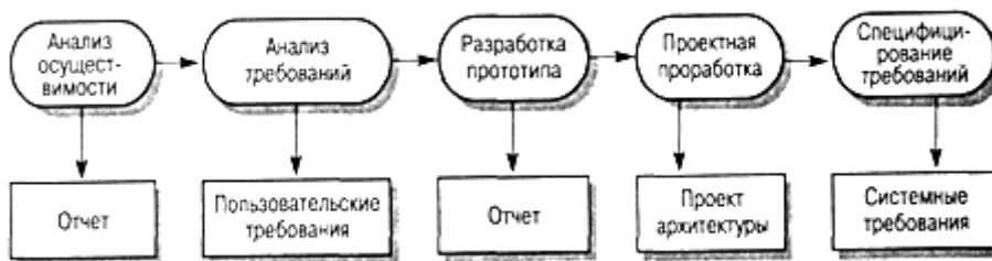
Рисунок 4.1 - Этапы процесса разработки спецификации
