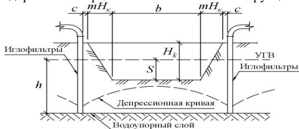
Рис. 6. Схема для расчета иглофильтровой установки
