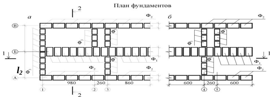
Рис. 1. Планы фундаментов и раскладки плит перекрытия над подвалом: l_1 а – для торцевой блок-секции; б – для рядовой блок-секции
