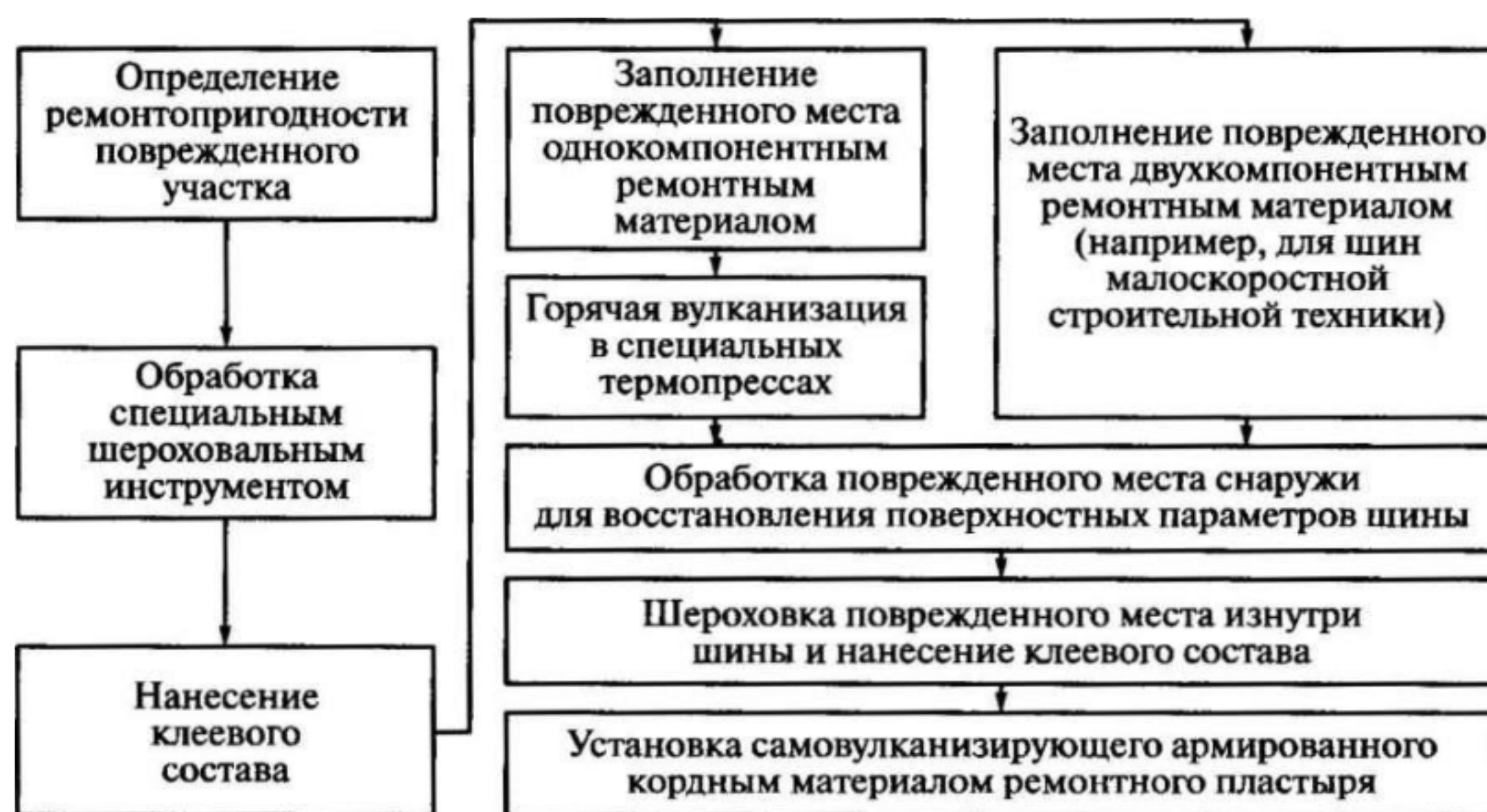
Рис. 6.8. Основные этапы ремонта сквозных повреждений шин
