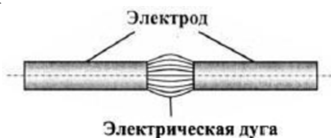
Рис.3. Принцип работы дуговой лампы
