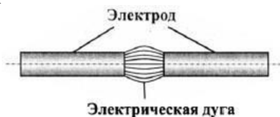
Рис.3. Принцип работы дуговой лампы
