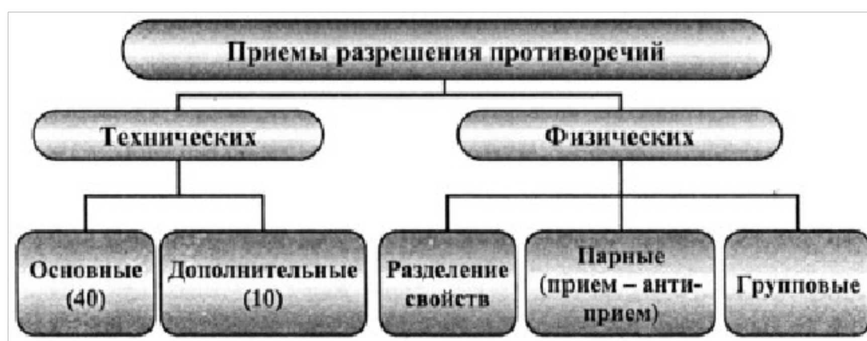
Рис. 1. Схема приемов разрешения противоречий
