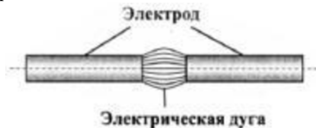
Рис.3. Принцип работы дуговой лампы
