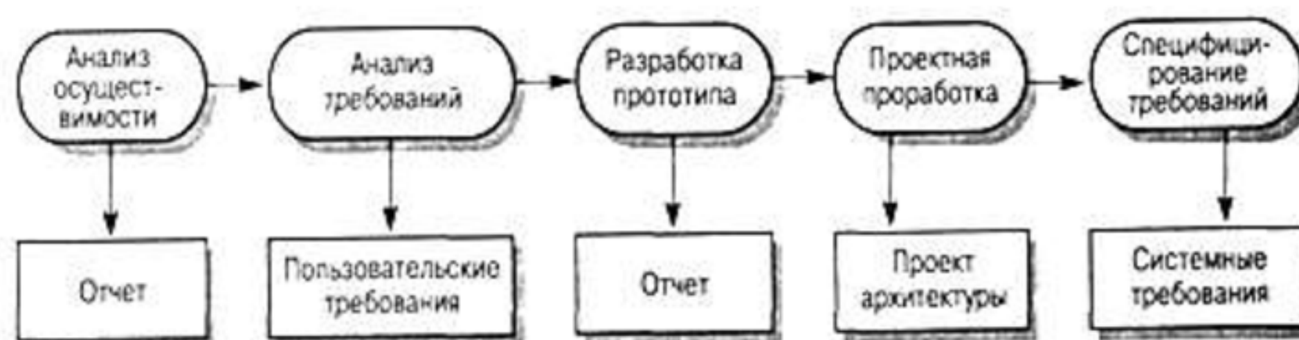
Рисунок 4.1 - Этапы процесса разработки спецификации
