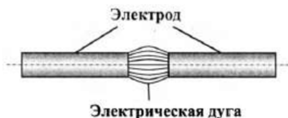
Рис.3. Принцип работы дуговой лампы
