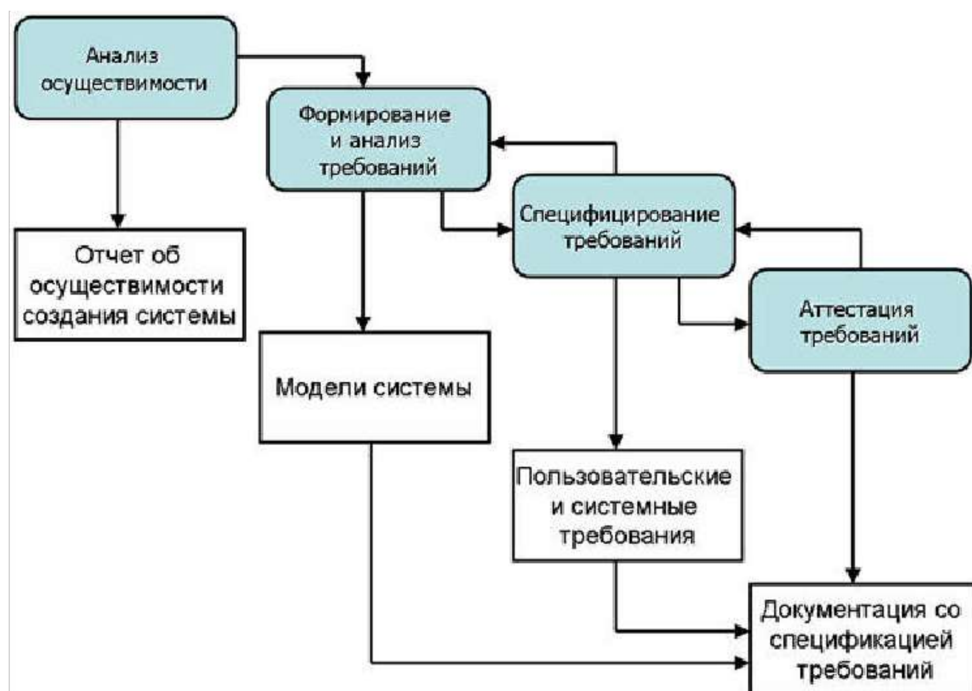
Рисунок 1.1 - Процесс разработки требований
