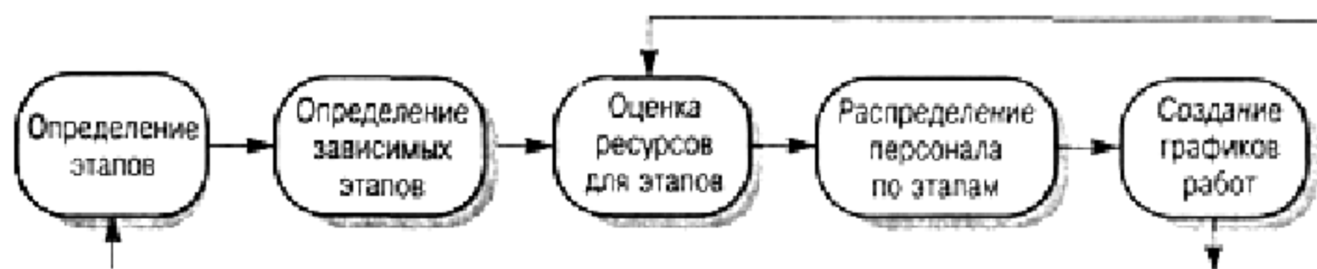
Рисунок 4.2 - Процесс составления графика работ
