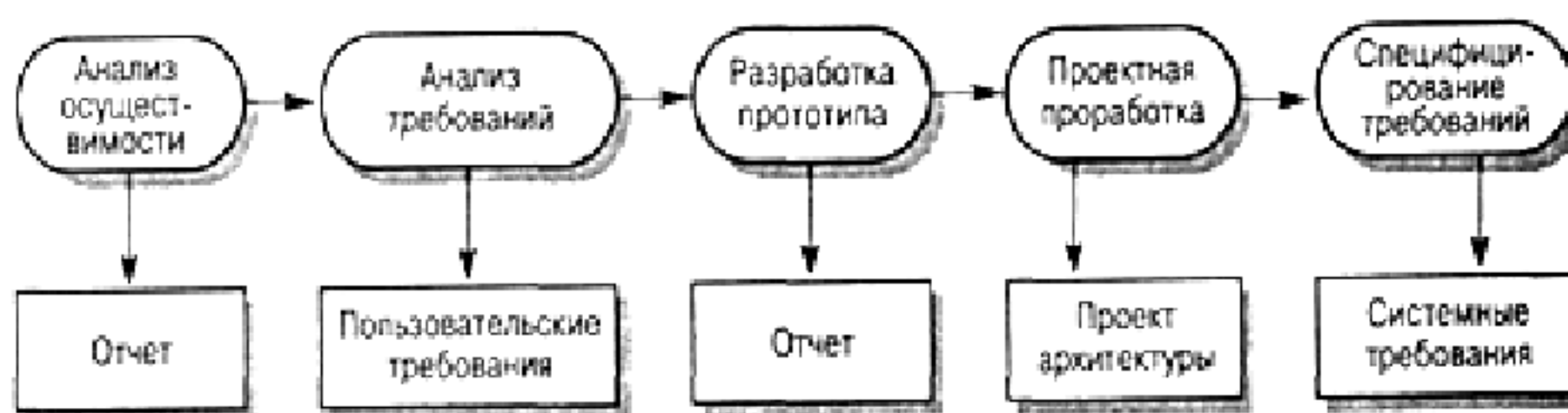
Рисунок 4.1 - Этапы процесса разработки спецификации
