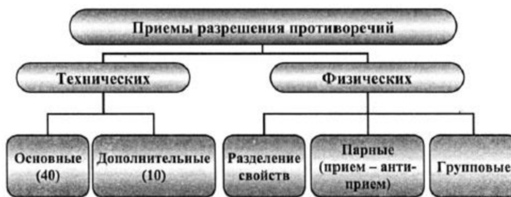
Рис. 1. Схема приемов разрешения противоречий
