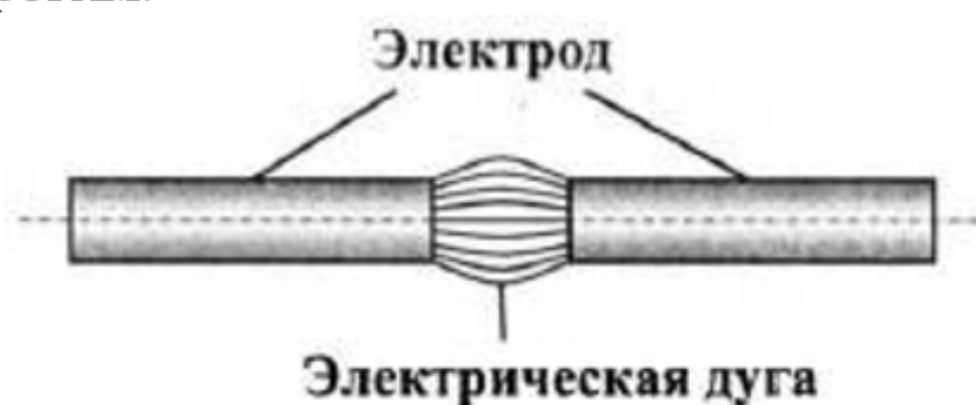
Рис.3. Принцип работы дуговой лампы
