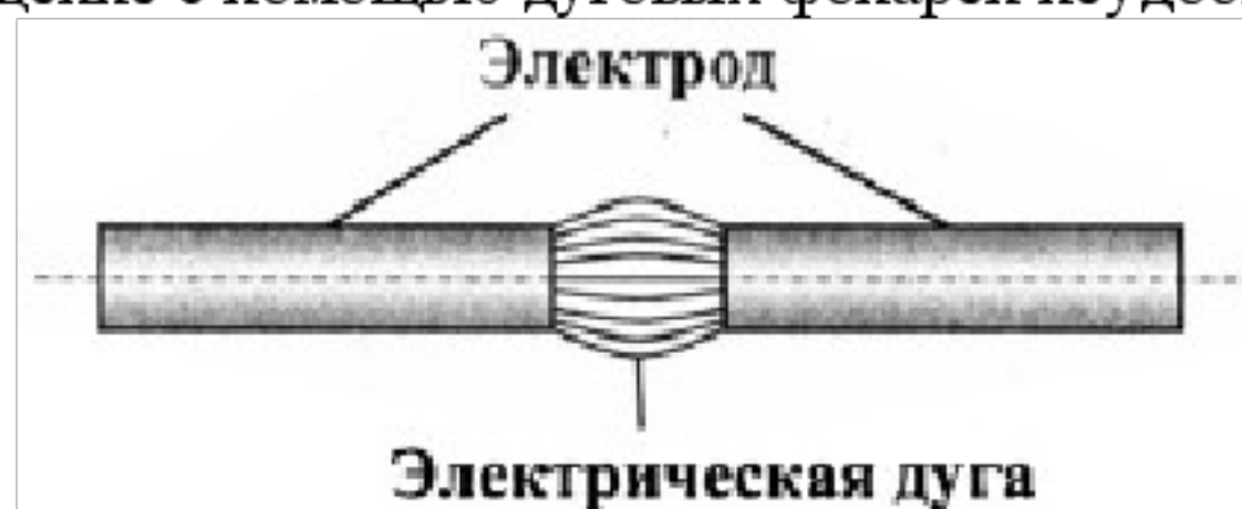
Рис.3. Принцип работы дуговой лампы
