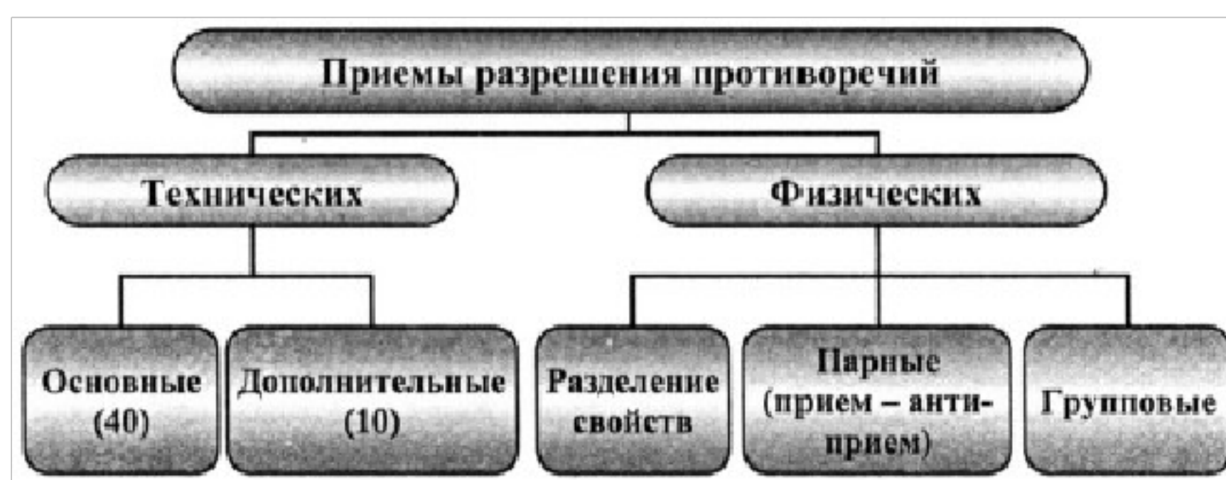
Рис. 1. Схема приемов разрешения противоречий
