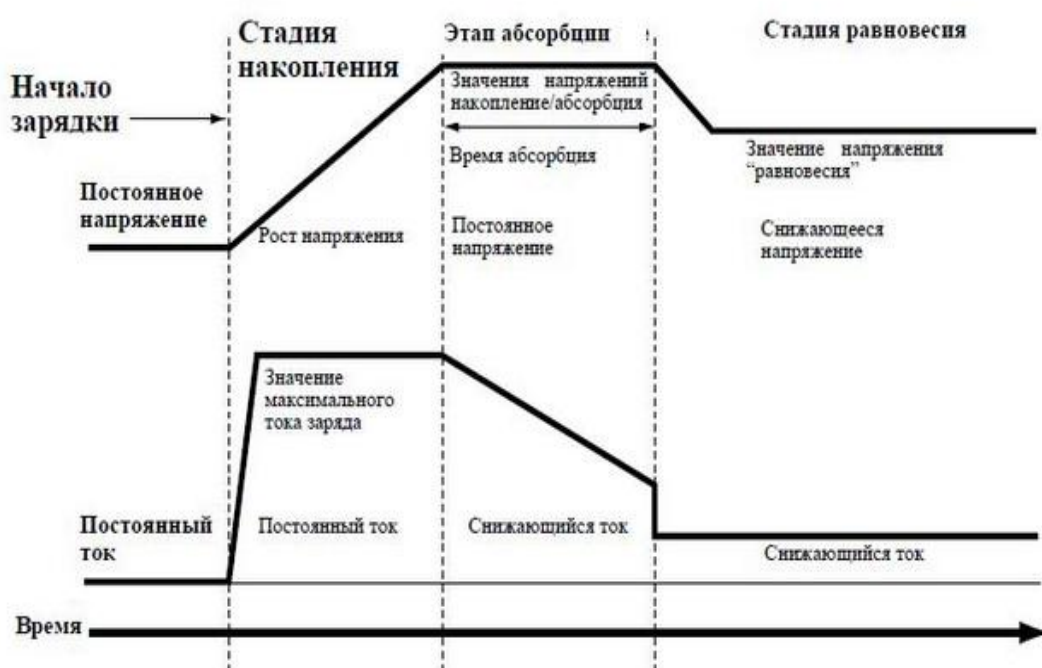
Рисунок 12 – Стадии управления зарядки АКБ
