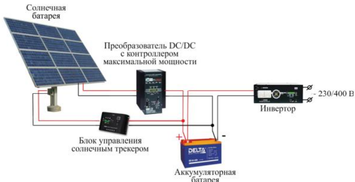
Рисунок 14 – Модель фотоэлектрической солнечной электростанции
