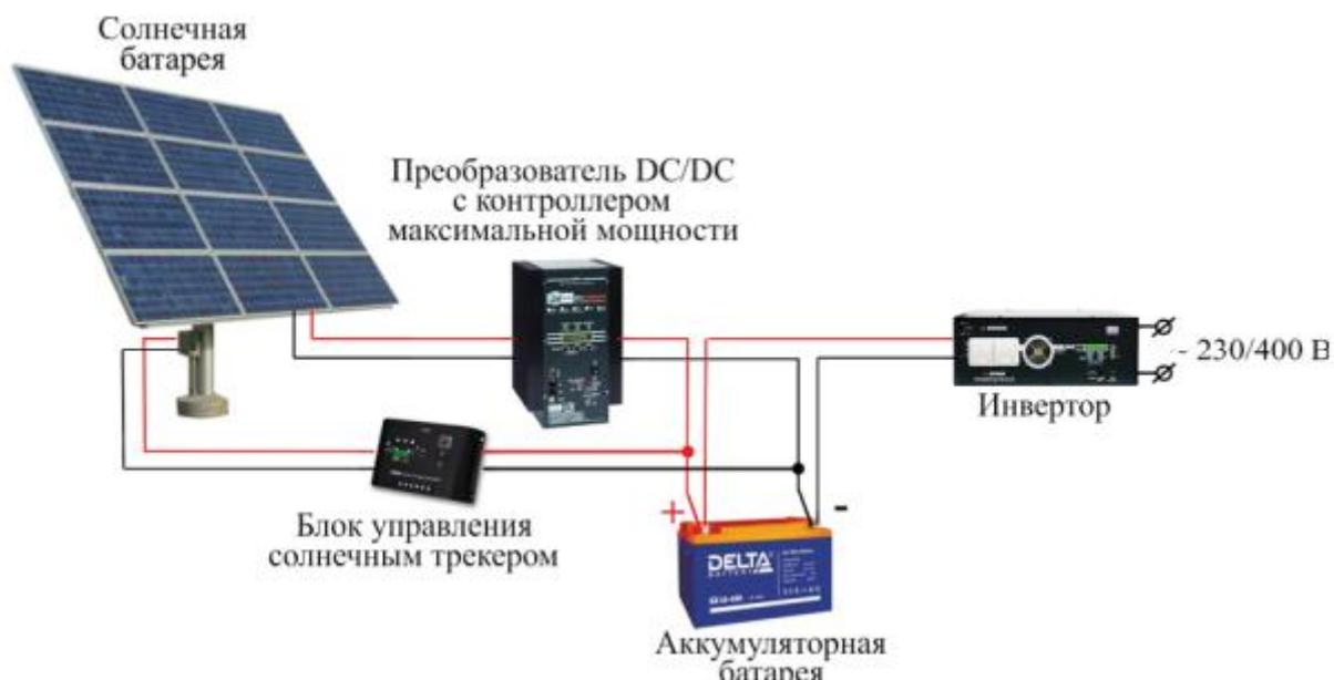
Рисунок 14 – Модель фотоэлектрической солнечной электростанции
