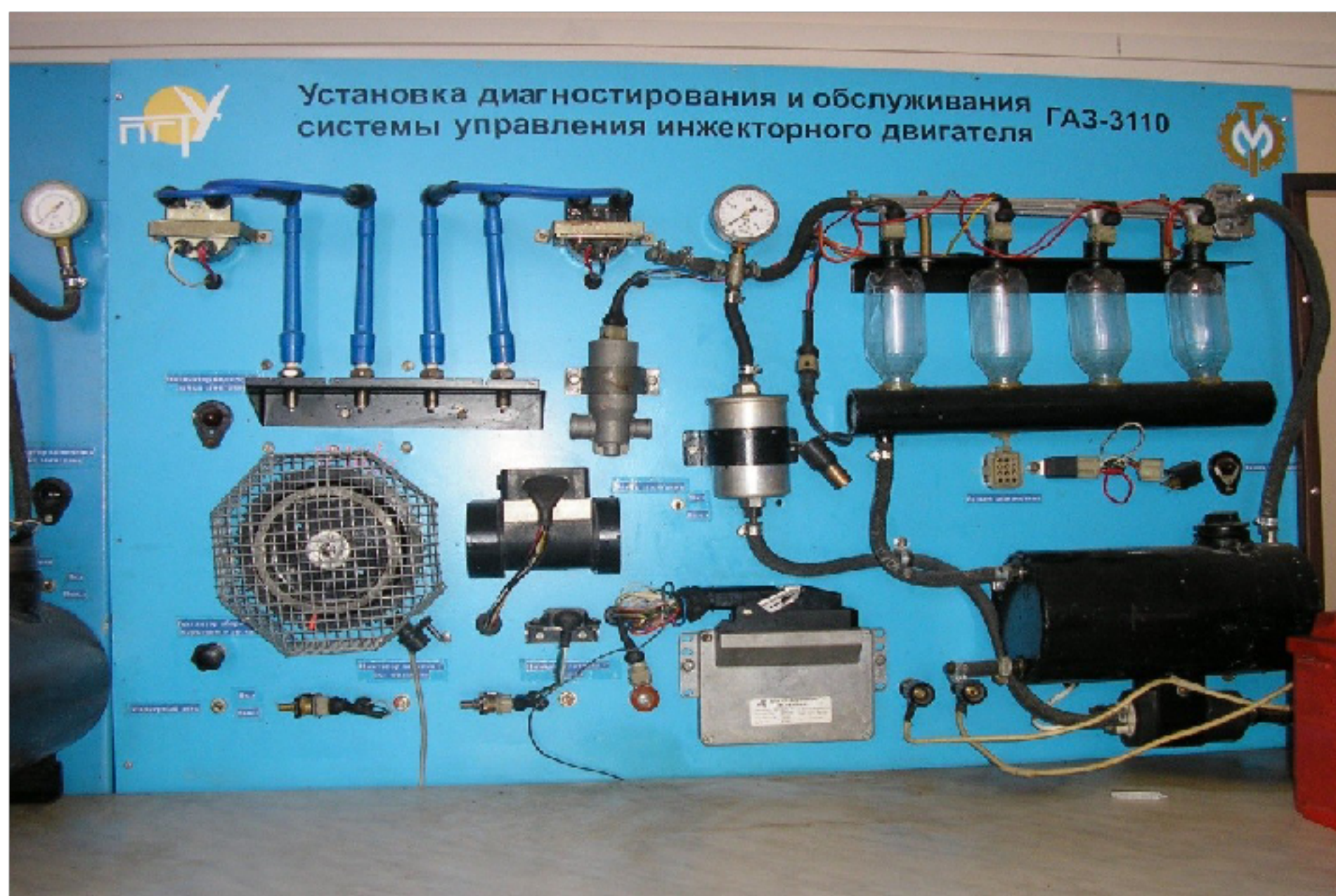
Рис. 14. Установка диагностирования и обслуживания системы управления инжекторного двигателя ГАЗ - 3110.
