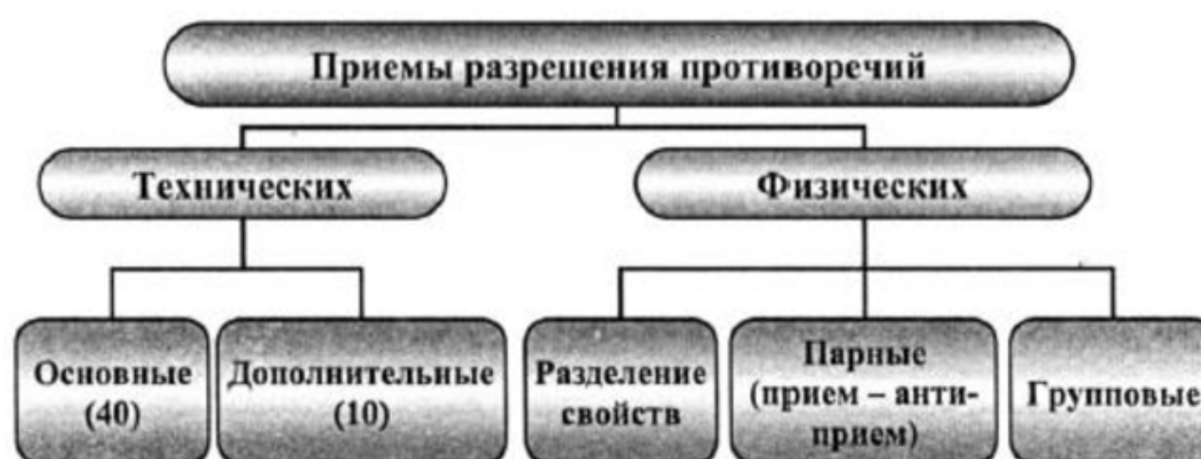
Рис. 1. Схема приемов разрешения противоречий
