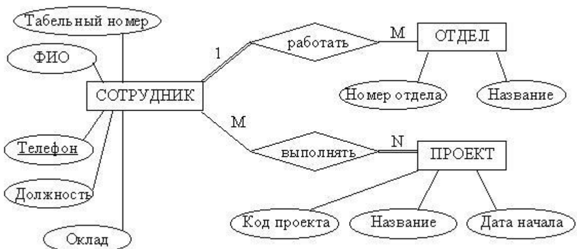
Рисунок 3.1 - Пример ER-диаграммы с однозначными и многозначными атрибутами
