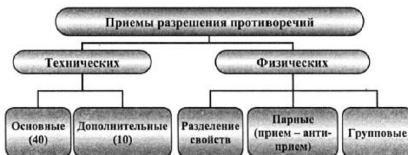
Рис. 1. Схема приемов разрешения противоречий
