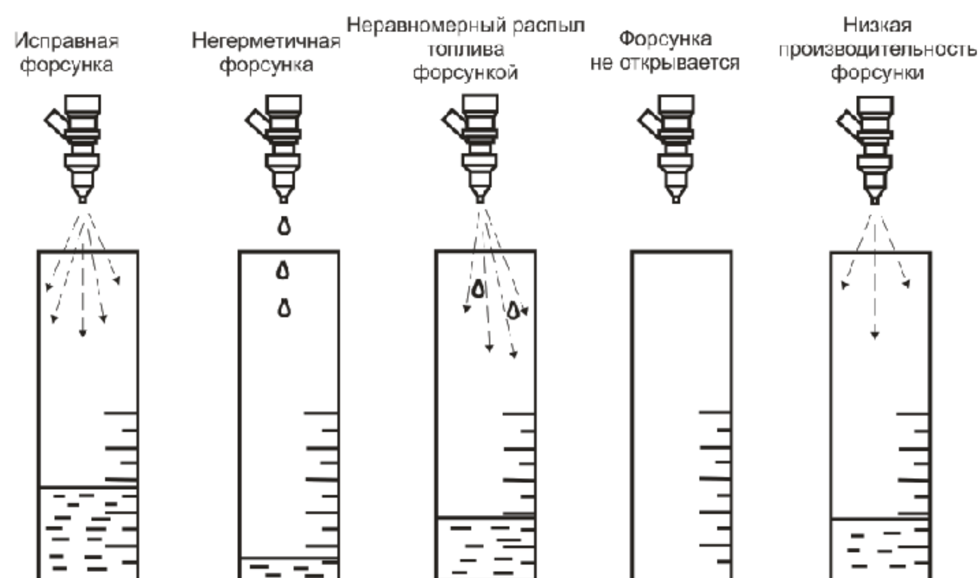
Рис. 27. Возможные варианты тестирования форсунок.
