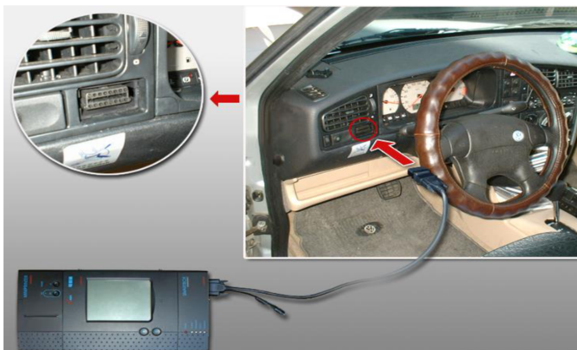
Рис. 10. Подсоединение сканера к автомобилю: 1 - сканер; 2 - основной соединительный провод; 3 – адаптер; 4 – разъем диагностики.
