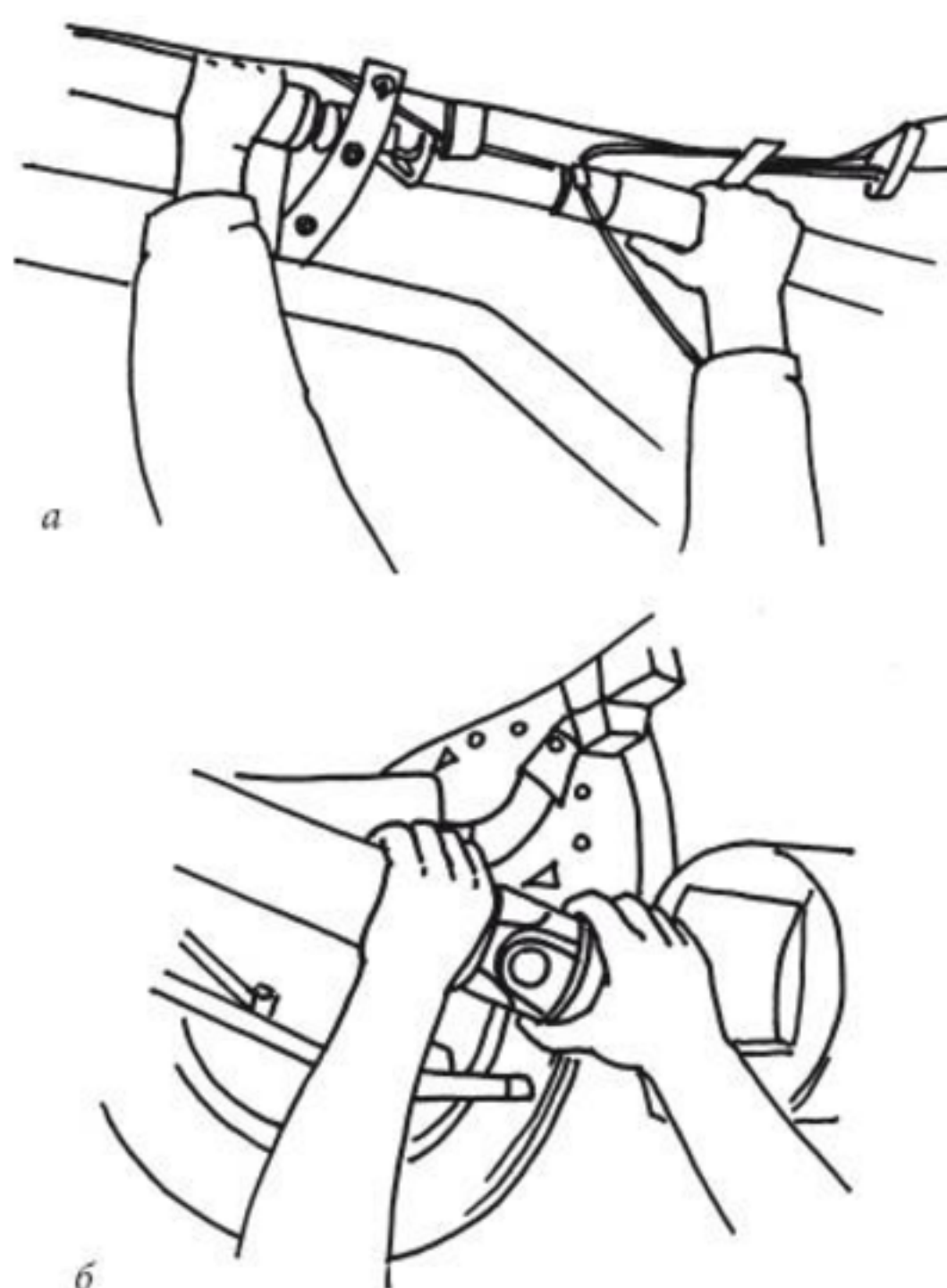
Рисунок 13. Проверка окружных зазоров
