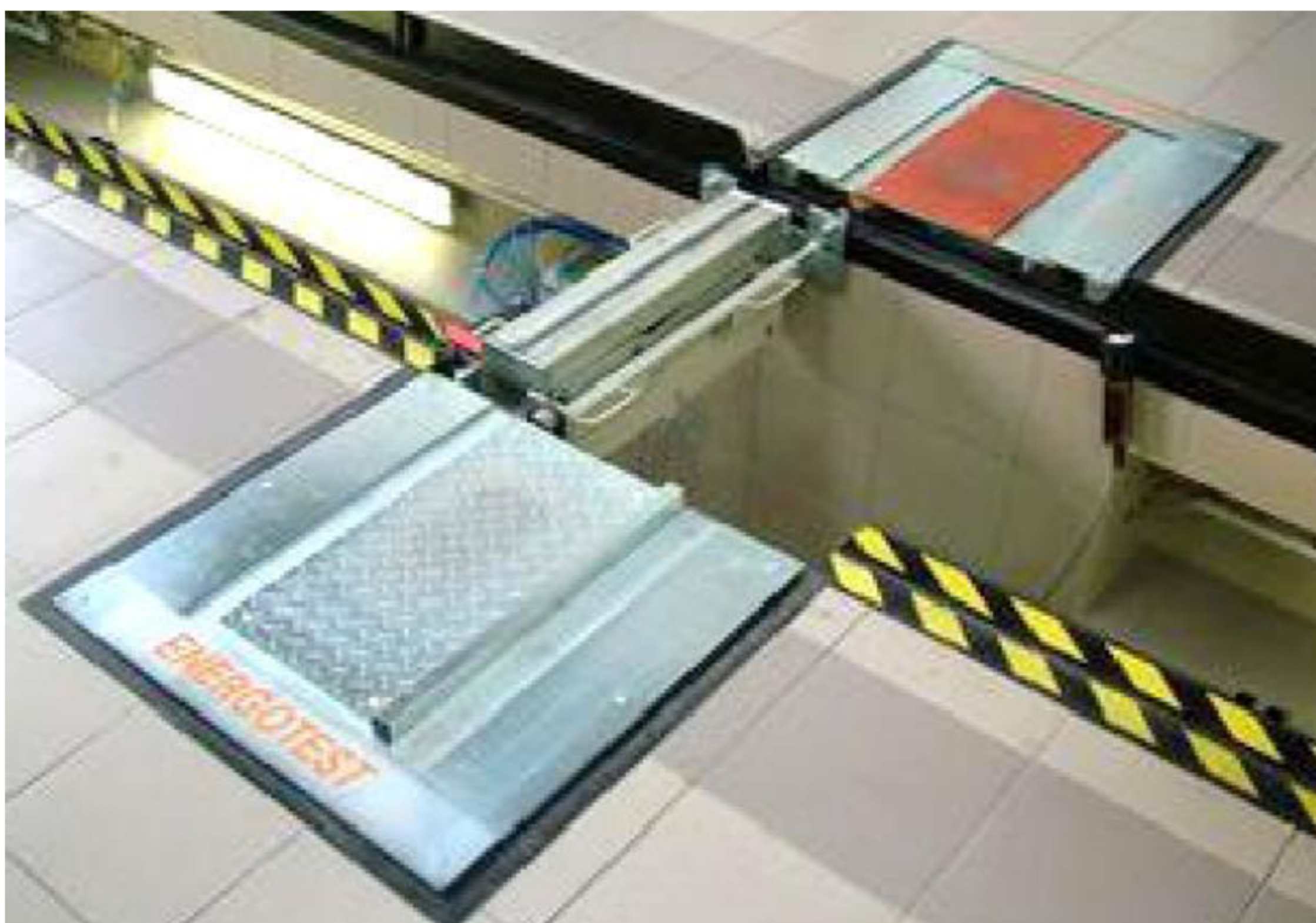
Рисунок 7. Общий вид детектора люфтов в подвеске автомобиля
