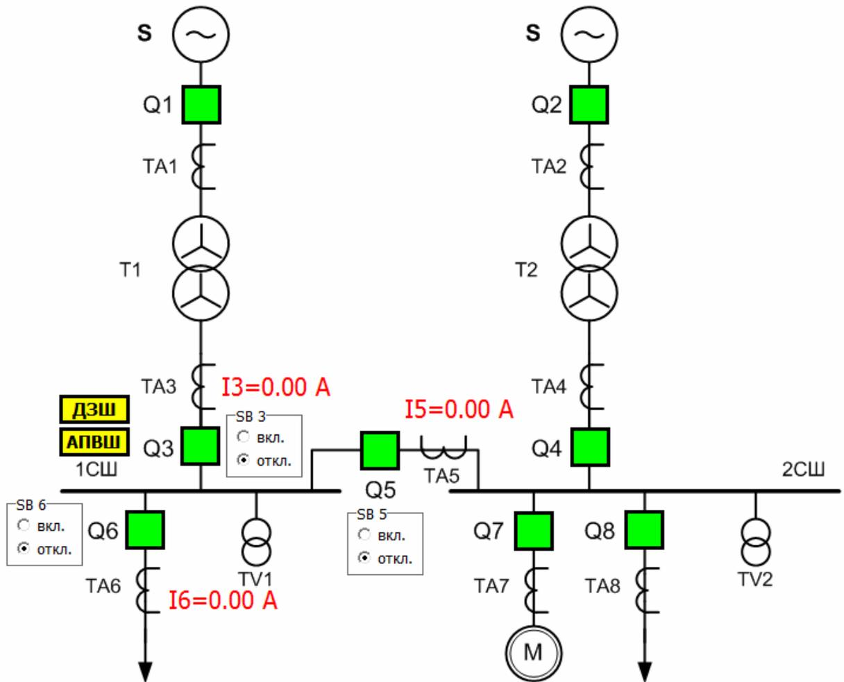
Рис. 9.2. Автоматическое повторное включение сборных шин. Мнемосхема
