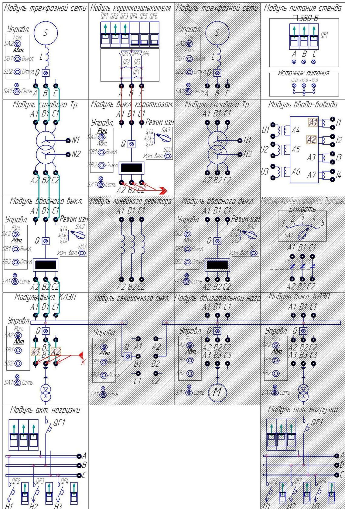
Рис. 8.1. Автоматическое повторное включение линии электропередачи.
