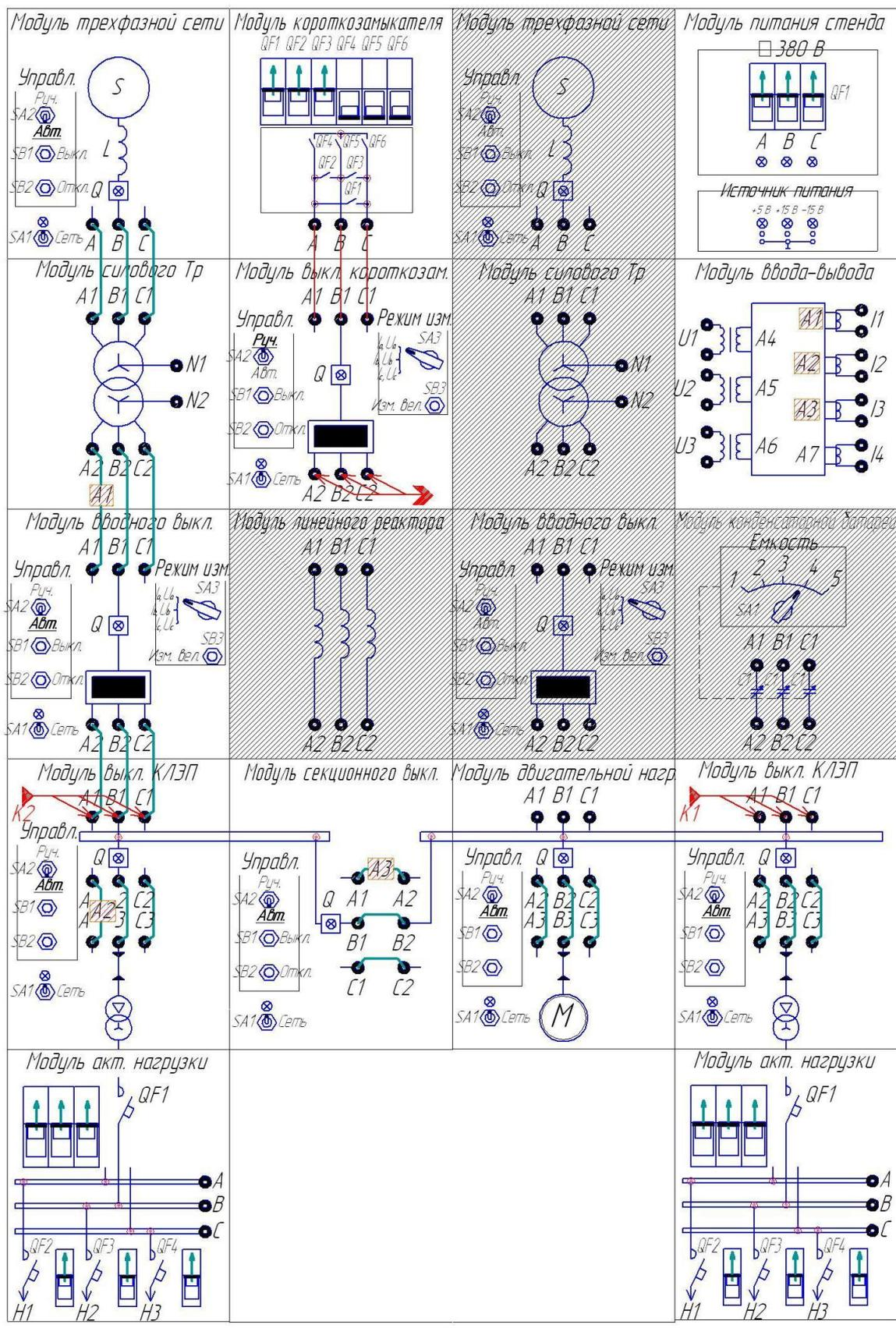
Рис. 6.1. Дифференциальная защита сборных шин. Схема электромонтажная
