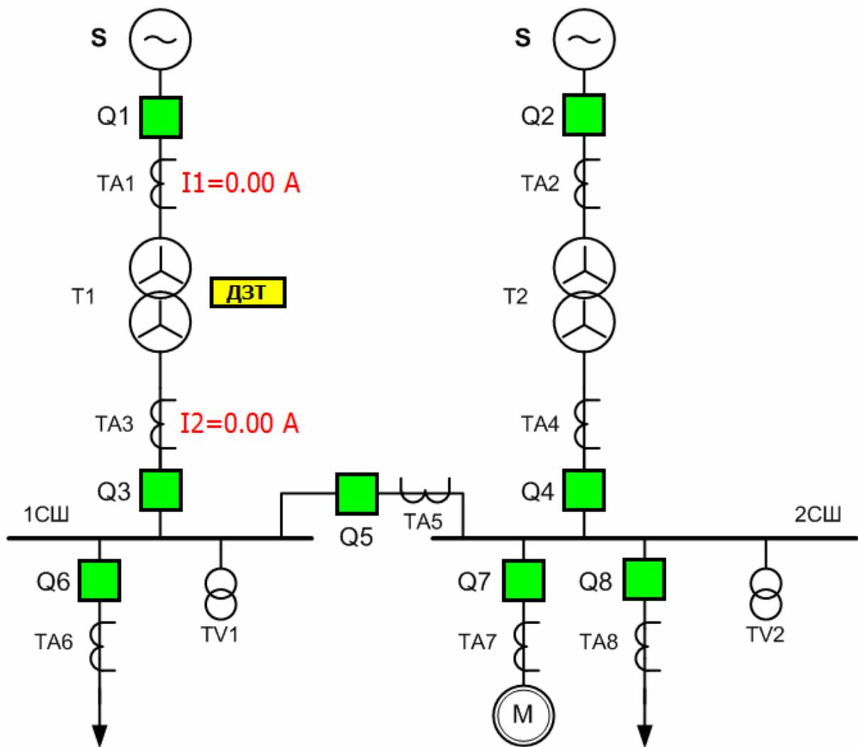
Рис. 4.2. Дифференциальная защита трансформатора. Мнемосхема
