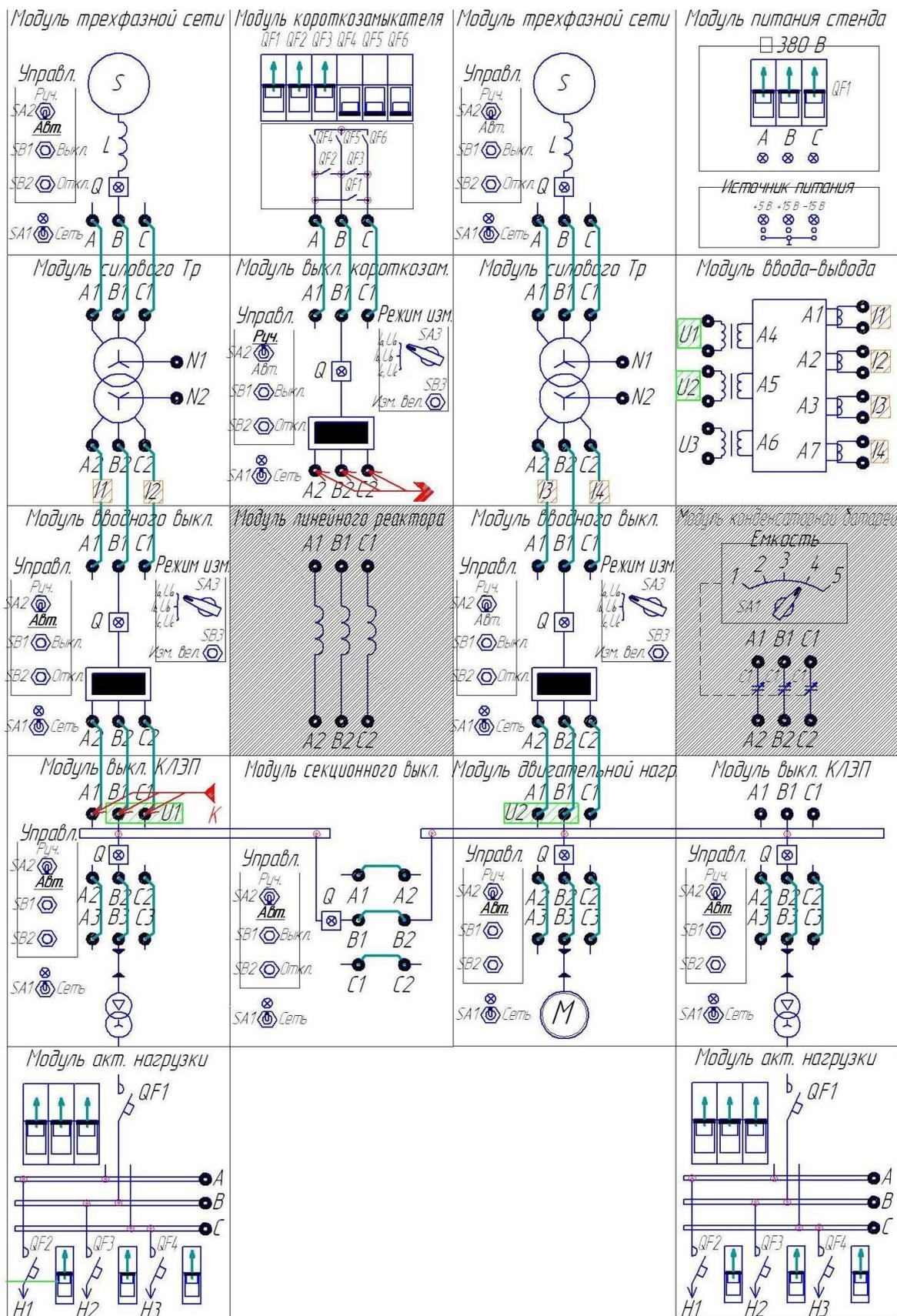
Рис. 10.1. Автоматическое включение резерва секционного выключателя. Схема электромонтажная
