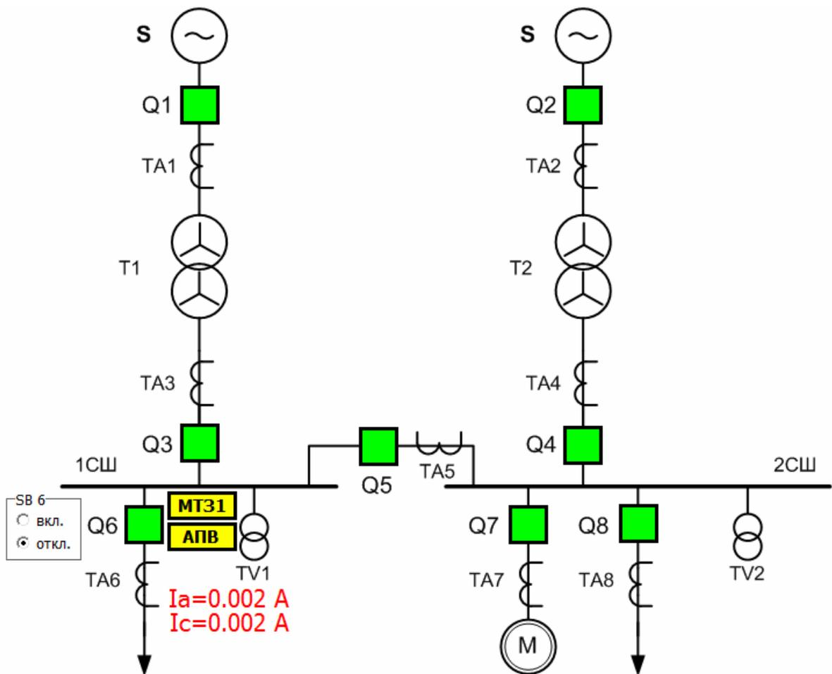
Рис. 8.2. Автоматическое повторное включение линии электропередачи.
