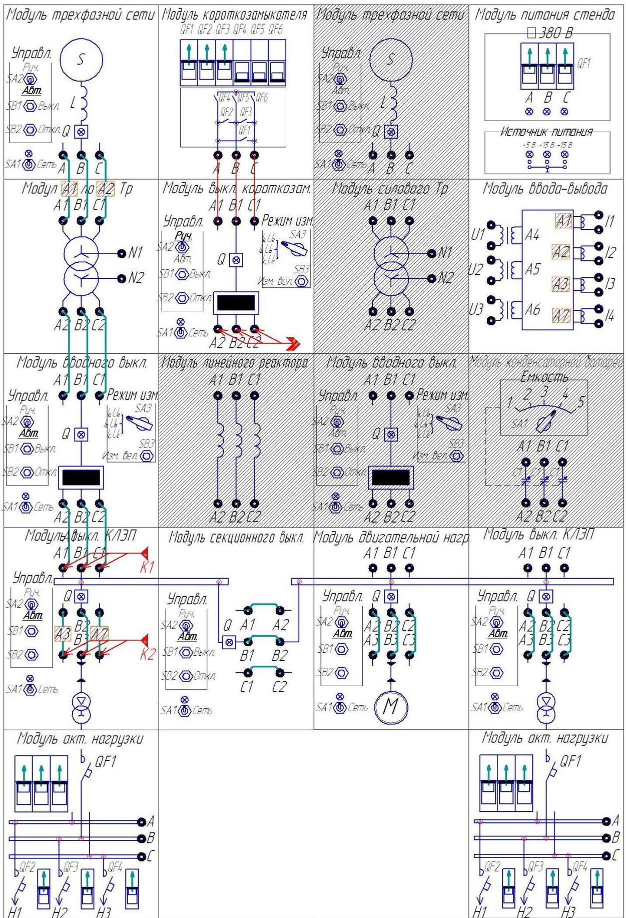
Рис. 7.1. Логическая защита сборных шин. Схема электромонтажная
