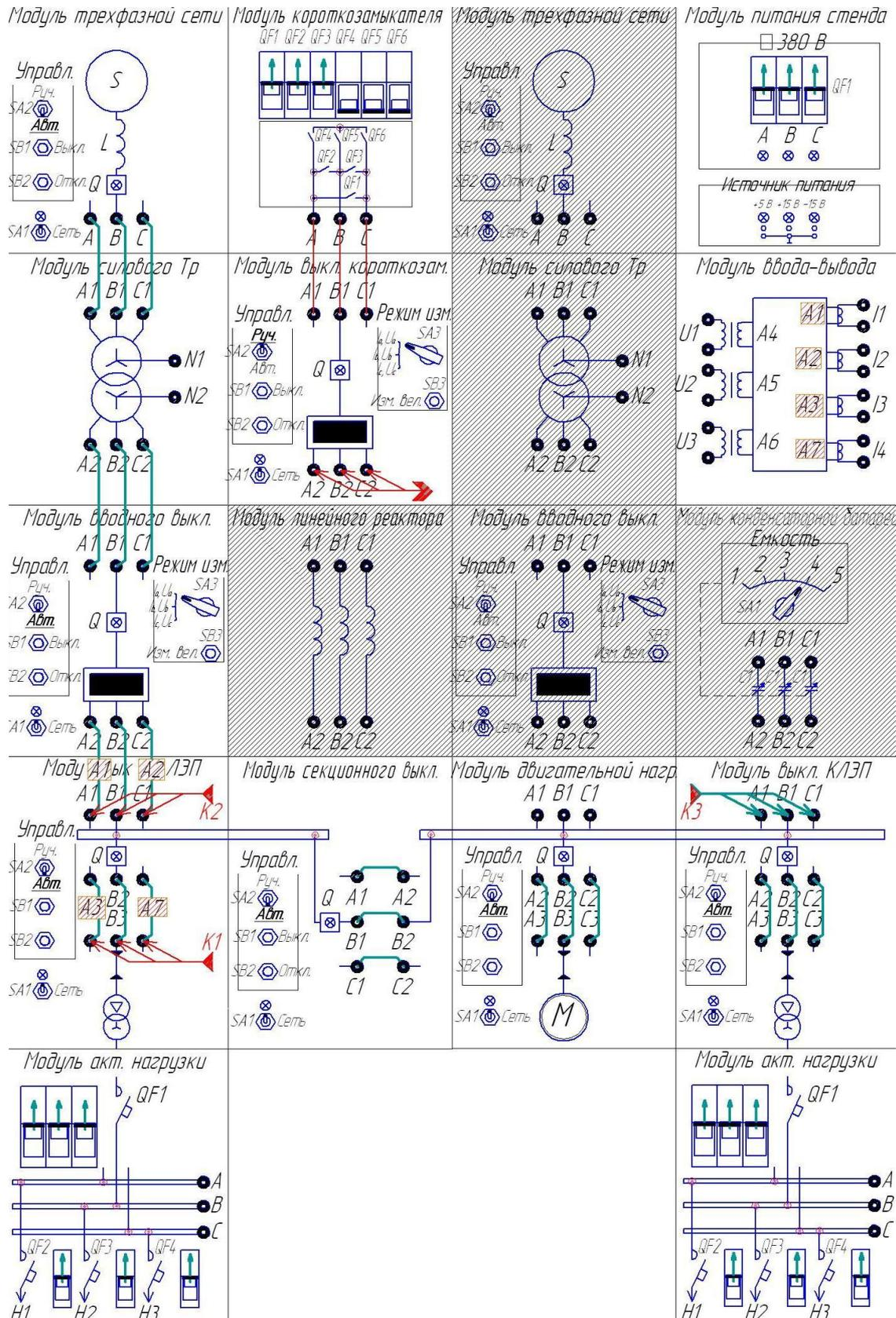
Рис. 2.1. Максимальная токовая защита с независимой выдержкой времени линии электропередачи и вводного выключателя. Схема электромонтажная
