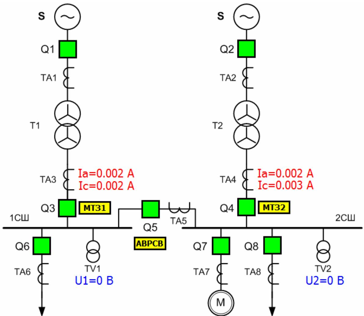
Рис. 10.2. Автоматическое включение резерва секционного выключателя.
