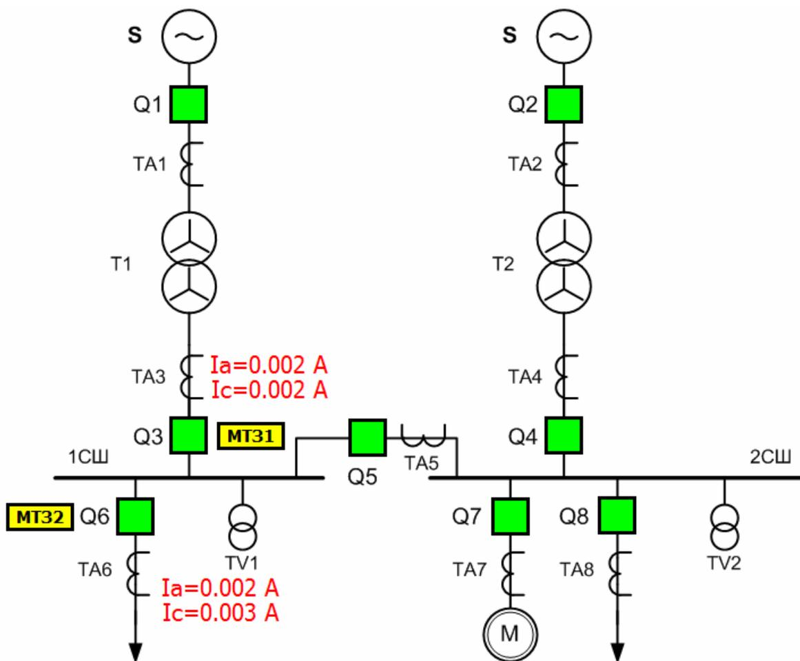
Рис. 7.2. Логическая защита сборных шин. Мнемосхема
