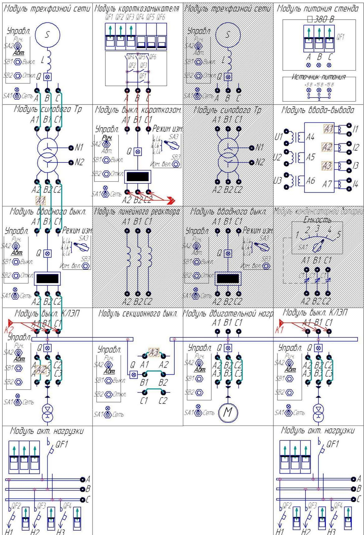
Рис. 9.1. Автоматическое повторное включение сборных шин. Схема электромонтажная
