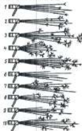
Рис. 3 Определение марки стали по искре
