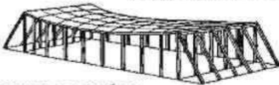
покрытие с железобетонными оттяжками /гаран в Косноярске/
