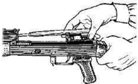
Рис. 15. Отделение затворной рамы с затвором
