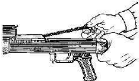
Рис. 14. Отделение возвратного механизма
