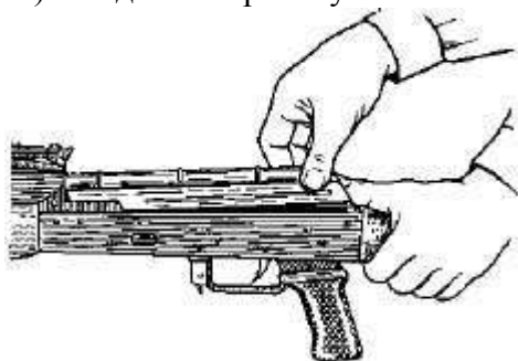
Рис. 13. Отделение крышки ствольной коробки
