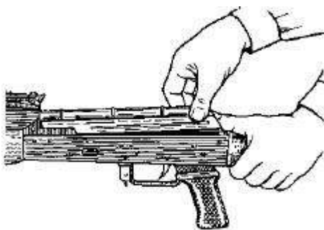
Рис. 13. Отделение крышки ствольной коробки
