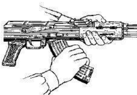
Рис. 19. Присоединение газовой трубки
