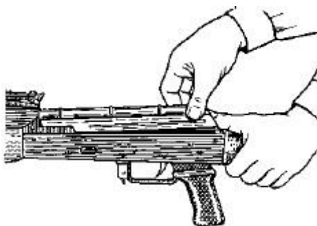
Рис. 13. Отделение крышки ствольной коробки
