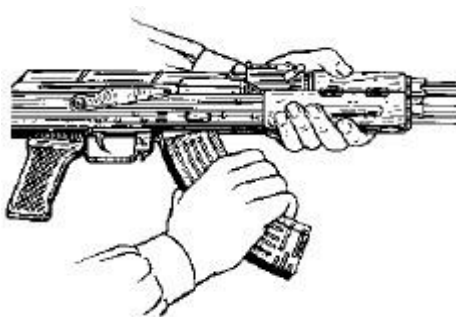
Рис. 19. Присоединение газовой трубки
