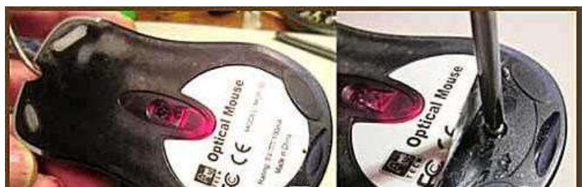
Рис.2а – Раскручивание компьютерной мыши
