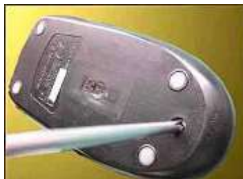
Рис.1 - Разбор компьютерной мыши
