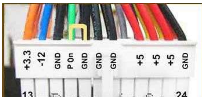
Рис. 11в - Цветовая маркировка проводов компьютеров.
