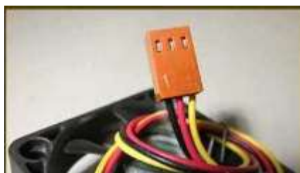
Рис. 4 б -Подключение кулера в компьютере
