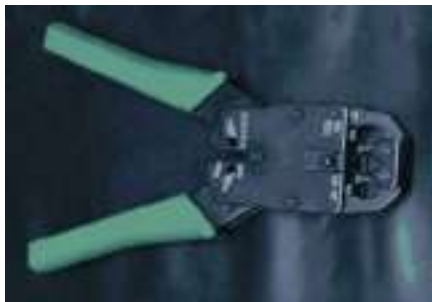
Приспособление для снятия изоляции и обжимки разъема
