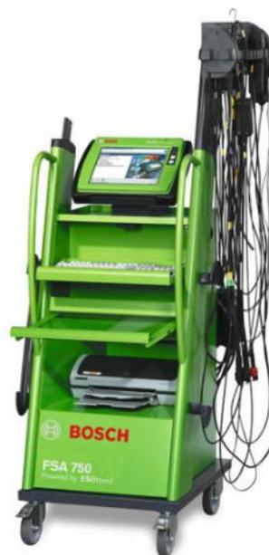
Рис. 6. Консольный мотортестер
