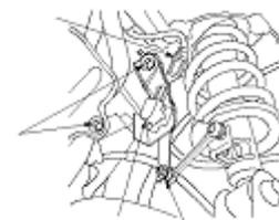
5. Проверьте неразрывность соединения между клеммой № 3 3P разъема датчика хода подвески и "массой" кузова.
