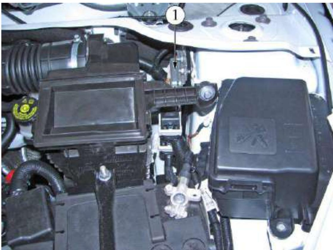
Рисунок 2.1 - Расположение контроллера в подкапотном пространстве автомобилей семейства LADA VESTA
