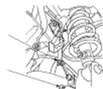
**ДА** - Пропадающая неисправность, на момент проверки система исправна. Проверьте контакт и крепления клемм в цепи между блоком управления автоматической регулировкой направления фар и датчиком хода передней (или задней) подвески; если провод в порядке, замените датчик хода передней (или задней) подвески.■
