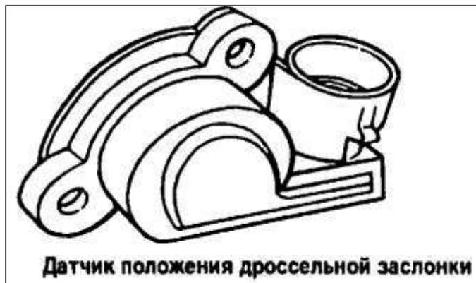
Рис. 4.21 Датчик положения дроссельной заслонки
