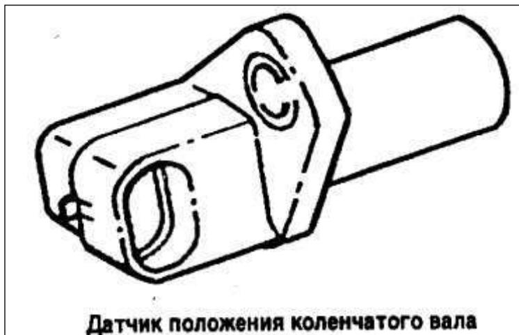
Рис.4.24. Датчик положения коленчатого вала
