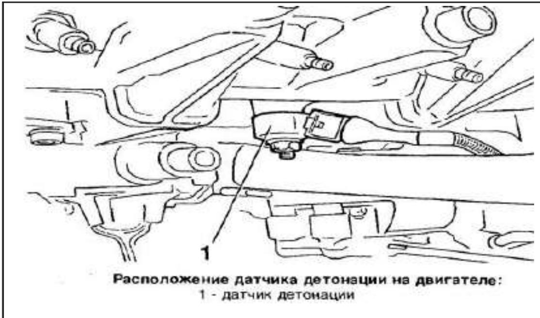
Рис. 4.8. Расположение датчика детонации на двигателе
