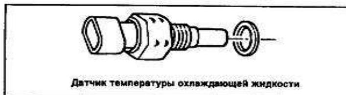
Рисунок 6.1 - Датчик температуры охлаждающей жидкости
