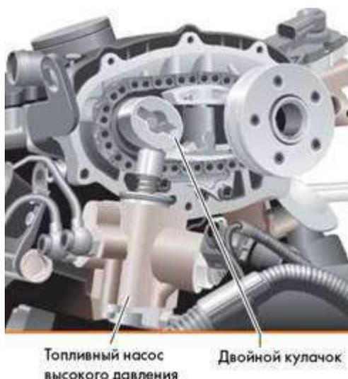
Рисунок 3.7 – Привод одноцилиндрового топливного насоса высокого давления
