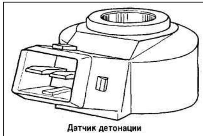
Рисунок 7.1 - Датчик детонации
