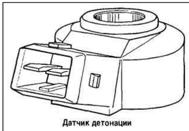
Рис.4.7. Датчик детонации
