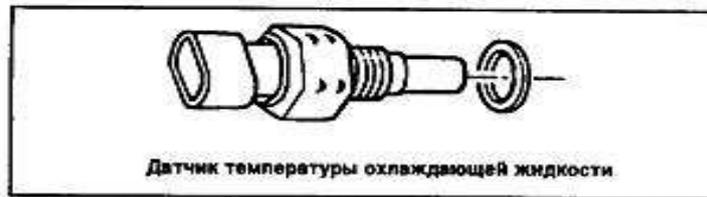
Рис. 4.3. Датчик температуры охлаждающей жидкости
