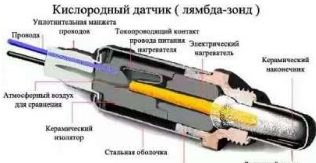
Рис.4.11. Датчик кислорода.
