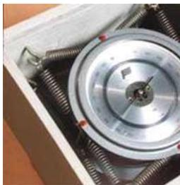
Барометр предназначен для измерения атмосферного давления и температуры воздуха внутри помещения при температуре воздуха от +10 до +50 °С и относительной влажности воздуха до 80 %.
