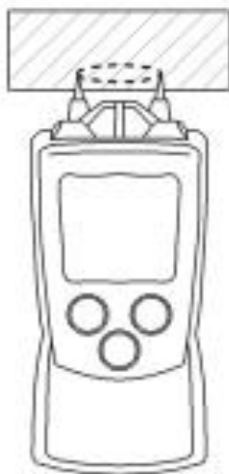
Рис. 14. Измерение влажности материала с помощью игольчатого влагомера
