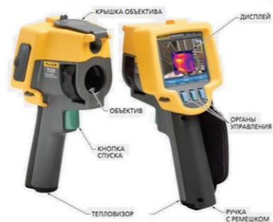
Рис. 1.3. Обычные тепловизоры имеют несколько общих компонентов, к которым относятся объектив, крышка объектива, дисплей, органы управления и ручка с ремешком.
