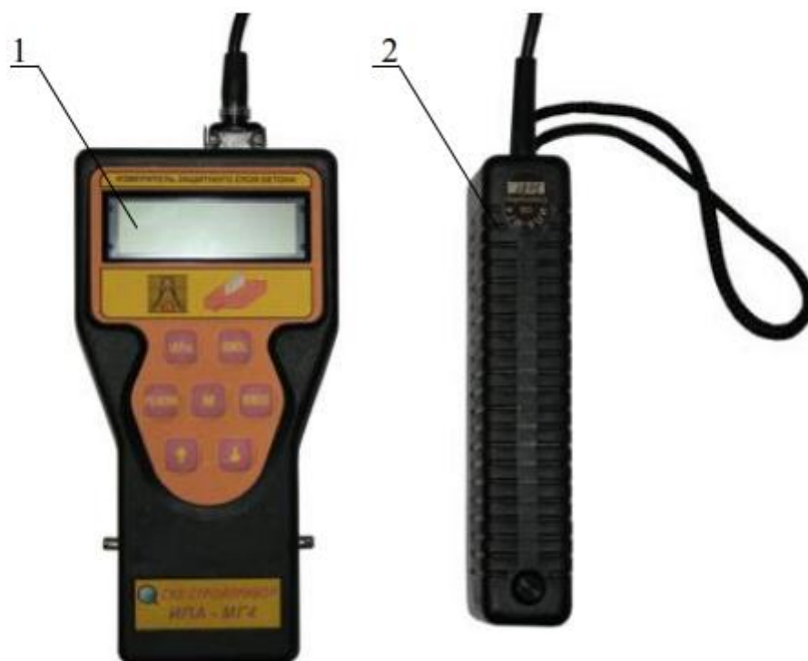
1 – электронный блок; 2 – преобразователь
