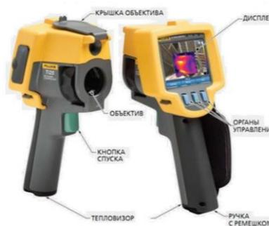
Рис. 1.3. Обычные тепловизоры имеют несколько общих компонентов, к которым относятся объектив, крышка объектива, дисплей, органы управления и ручка с ремешком.
