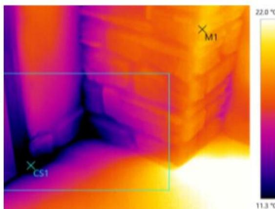
На термограмме, снятой снаружи помещения, ситуация меняется на противоположную и дефектом может считаться оранжевый и красные цвета. Точка HSI соответствует максимальной температуре на поверхности объекта, когда M1 – реперная точка.
