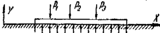
Рис.1. Расчетная схема балки на упругом основании.
