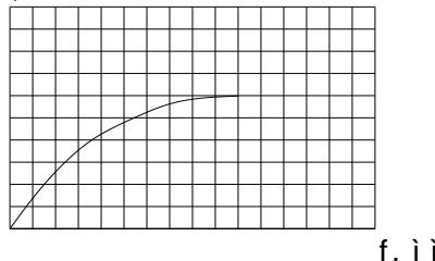
По величинам прогибов балки при нагрузках  $0,125 P_{\text{расчет}}$  и  $0,25 P_{\text{расчет}}$  можно вычислить усредненный модуль упругости древесины образца при кратковременном нагружении и оценить влияние поперечной силы на прогиб данной балки. Для этого по показаниям индикатора определяем прогиб балки в середине пролета и вычисляем усредненный модуль упругости древесины без учета влияния поперечной силы.
