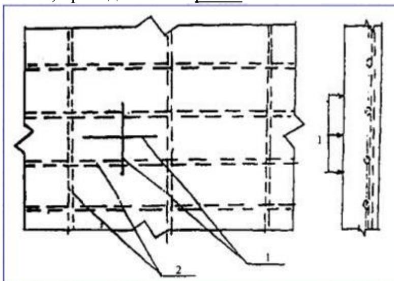
1 - положение прибора при испытании; 2 - расположение арматуры
