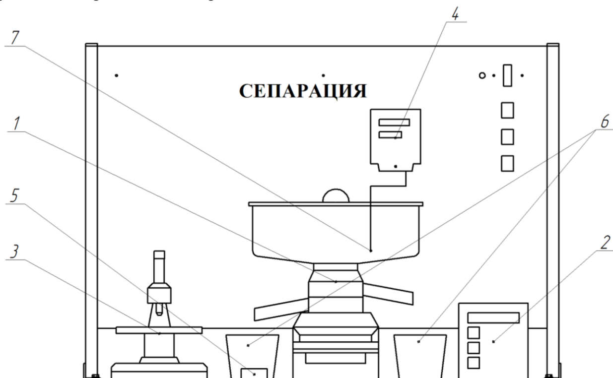
Рисунок 1.3 – Основной вид лабораторной установки: 1 – сепаратор, 2 – анализатор Лактан 1-4М, 3 – микроскоп, 4 -измеритель ТРМ 200, 5 – РНметр, 6 - емкости для сбора сливок и обрат, 7 – датчик температуры
